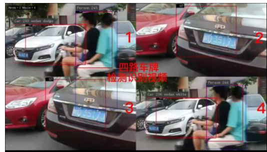
图 4 电瓶车与行人的检测
